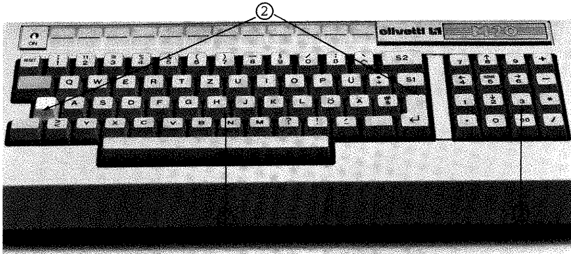
Alphanumerische Tastatur, auch verfügbar als ASCII-Version mit BASIC-Ganzworten
