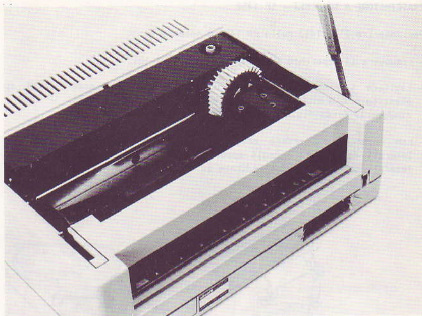
Figura 4-11 Rimozione dei coperchietti pre-tranciati
