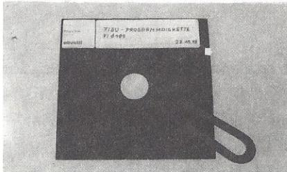
Keine Magnete oder magnetisierten Gegenstände in der Nähe der Disketten verwenden. Daten können auf einer Diskette verloren gehen, die einem magnetischen Feld ausgesetzt wird.
