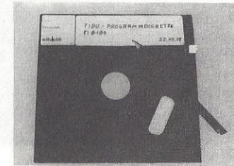
Radieren auf aufgeklebten Schildern oder Radieren in der Nähe von Disketten kann die Funktionsfähigkeit der Diskette beeinträchtigen. Der Radierstaub könnte in die Diskette gelangen und dies sollte vermieden werden.
