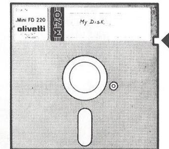
Die Schreibschutzkerbe in der Plastikschrutzhülle schützt die Mini-Diskette gegen unbefugtes Aufzeichnen. Zu diesem Zweck wird ein spezieller Schutz über die Aussparung geklebt. Soll die Diskette erneut beschrieben werden, braucht nur der Kerbenschutz von der Diskettenhülle entfernt werden.
